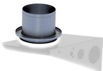
Racor para brazo articulado serie IBF para la conexión de repisas de pared con manguera en sistemas centralizados o instalaciones para la conexión a un extractor remoto. Collar de acero galvanizado con borde para empalme en manguera Ø 160 mm. Los datos de rendimiento se han medido con instrumentos adecuados en nuestros laboratorios.
