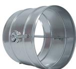
Compuerta circular de mariposa con control gradual de chapa de acero galvanizado que se debe instalar para tener un mayor control sobre el caudal y la velocidad del aire, y para regular las prestaciones del extractor de manera tal que funcione con sus parámetros estándar.
